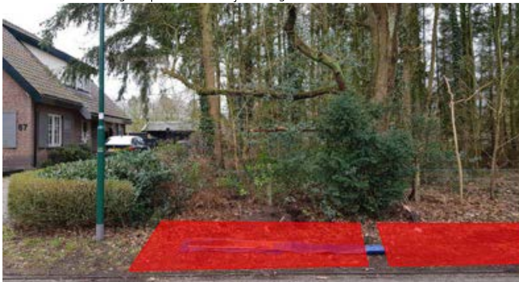
Foto 10. De aanleg van parkeervakken bij boom 1 geeft wortelverlies.
